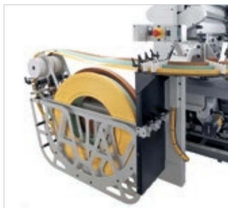
Cantos finos o de espesor, pre-cortados o en bobina, con alimentación automática o manual.
