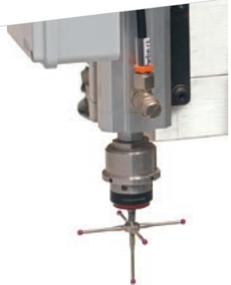
El **palpador de cruz** permite medir con la máxima precisión las dimensiones del panel.
