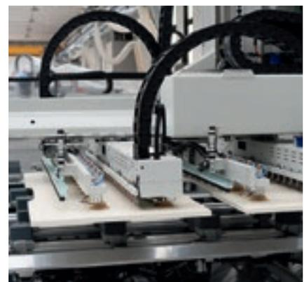
Hay disponibles dos tipos de **lector de código de barras** para leer los códigos de barras tanto en la cara superior como en la cara lateral del panel, mediante los que es posible cargar el programa de procesamiento correcto en la lista, evitando así errores por parte del operador.
